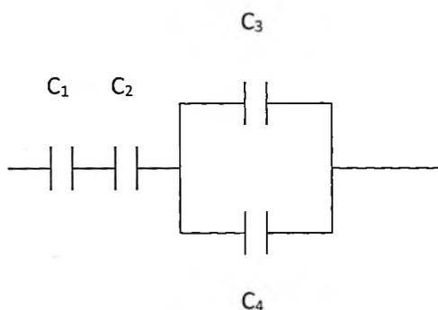
1. Вычислить общую ёмкость цепи, изображенную на рисунке, если  $C_1 = 5$  пФ,  $C_2 = 3$  пФ,  $C_3 = 2$  пФ,  $C_4 = 3$  пФ
